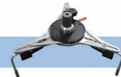
Nouvelle griffe Accropneu permettant le dévoilage en poussant
