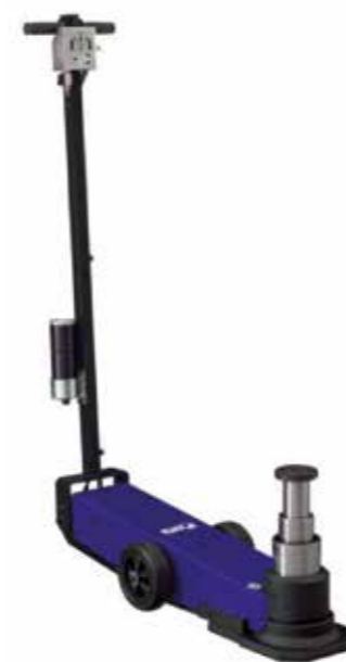
Cric 18T, 30T, 60T - Hauteur de levée 180/418 mm, 3 étages de vérins 163 9073
