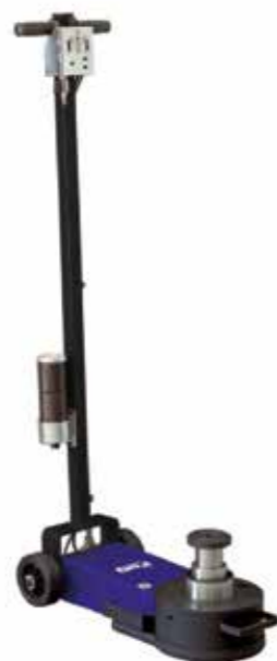
Cric 15T, 30T, 60T - Hauteur de levée 120/255 mm, 3 étages de vérins 163 9070
