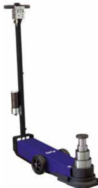
Cric 13T, 23T, 43T, 70T - Hauteur de levée 150/400 mm, 4 étages de vérins 163 9072
