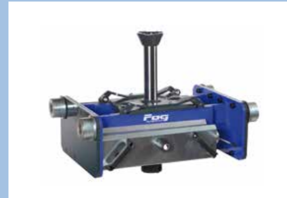
Traverse de levage 10T sans rails, pour ATLAS 451 9801 / 451 9802 / 451 9803
